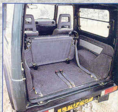
Met de achterbank in zitpositie biedt de Suzuki een wel heel kleine laadruimte. Na twee vleugelmoertjes te hebben losgedraaid kan het bankje echter worden neergeklapt.
