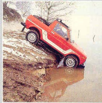
De Suzuki heeft vóór een vrijloophoek van 47° en achter een van 34°, zodat hij geen moeite heeft met scherpe knikken.
