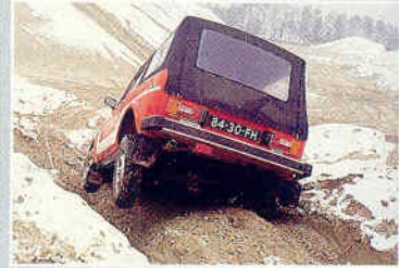
De Suzuki heeft vóór een vrijloophoek van 47° en achter een van 34°, zodat hij geen moeite heeft met scherpe knikken.
