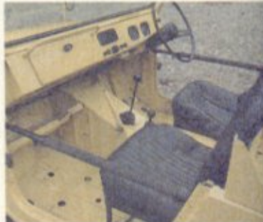
リブを入れて、強度を上げたインナーボディ。2型から るはすのパーキングブレーキロックがなぜか設置されて
