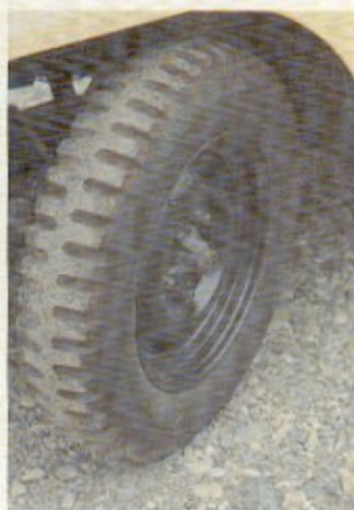
LJ10の初期型は本来は6プライのタイヤなのであるが、撮影車に装着されていたのは4x4用に採用された4プライタイヤ。
