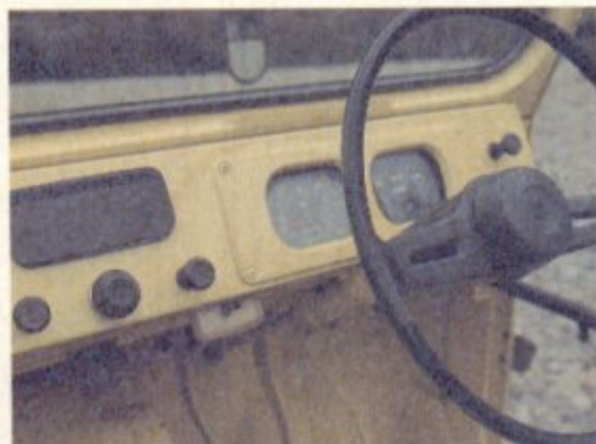
シンプルなインパネ。センターの灰皿の下のレバー類は、左からチョーク、ウィン ドウォッシャー、ワイパーをそれぞれ作動。メーターの右上はライトのスイッチ。
